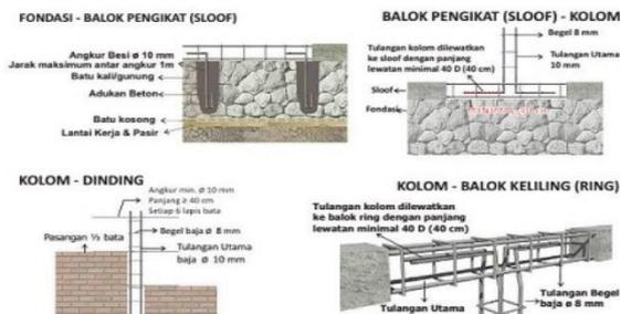
Gambar 4. Perkuatan Pada Dinding
