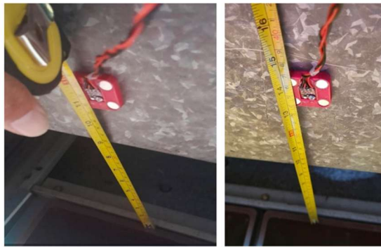
Gambar 6. Jarak sensor dari durfur /kontak finger 30 cm dan 35 cm
