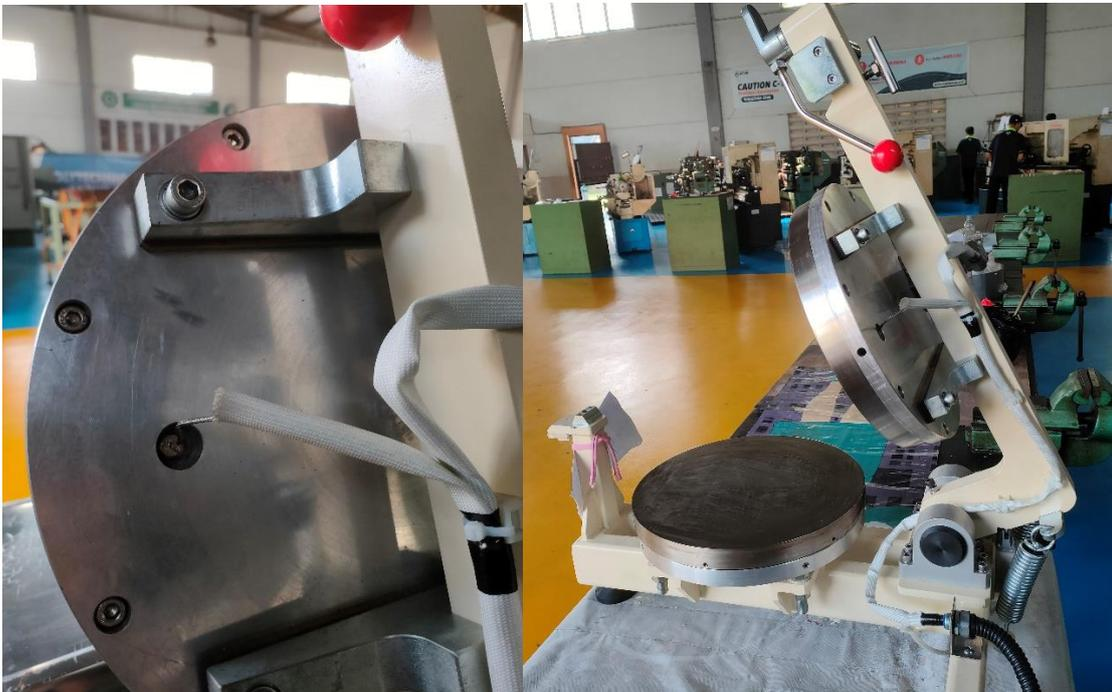
Gambar 7. Penempatan Sensor Termokopel.
