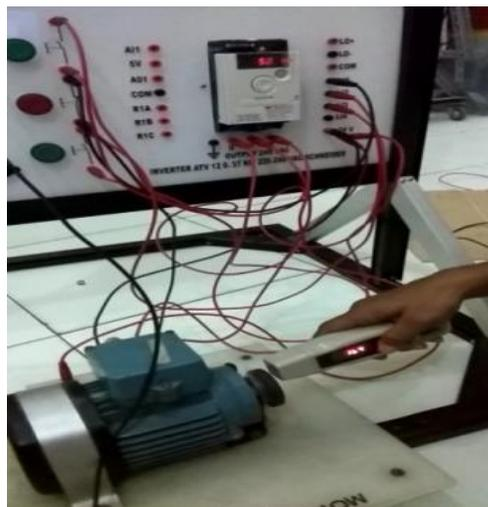
Gambar 3.1 Pengukuran Rpm untuk frekuensi 5 Hz
