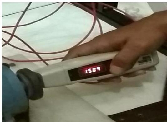
Gambar 3.3 Pengukuran Rpm motor frekuensi 50.Hz
