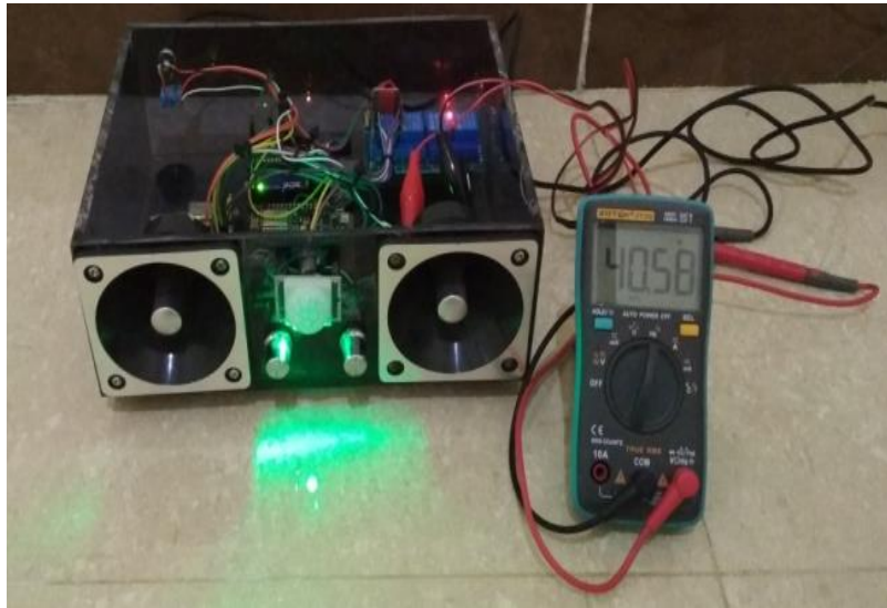
Gambar 4. Proses Pengukuran Frekuensi Gelombang Ultrasonik
