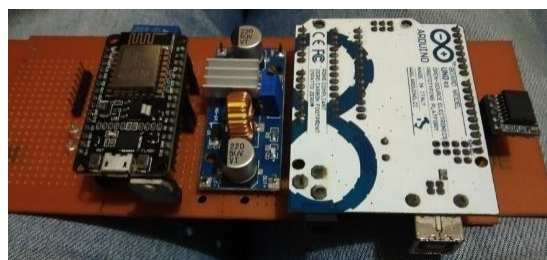
Gambar 3.4 Hasil Perancangan Rangkaian Sistem Kontrol Alat Penyiram Tanaman Otomatis.
