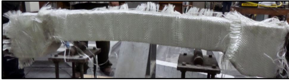
Gambar 2. Kerusakan Pada Kolom Perbaikan 60%
