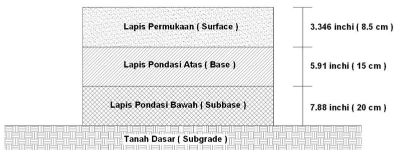
Gambar 2 Ketebalan tiap lapisan perkerasan
