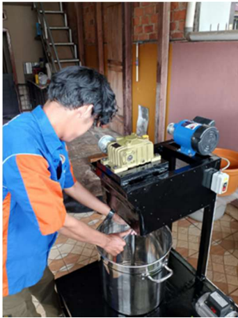
Gambar 5. Pemasangan Poros Pengaduk
