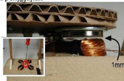
Gambar. Jarak magnet dengan lilitan
