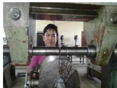
Gambar 7. Proses Pembubutan Roda Gigi
