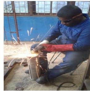
Gambar 5. Proses Meratakan Permukaan Pipa
