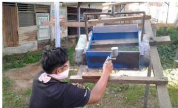
Gambar 10. Pengecatan Rangka dan Cover
