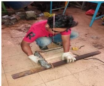
Gambar 2. Pemotongan besi siku
