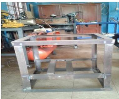
Gambar 4. Rangka Alat Pengupas Sabut Kelapa
