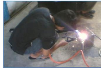
Gambar 30. Proses pembuatan housing gear box
