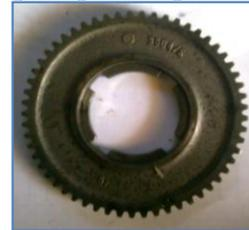
Gambar 21. Gear pada poros input
