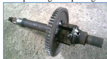
Gambar 24. Gear input dan poros input
