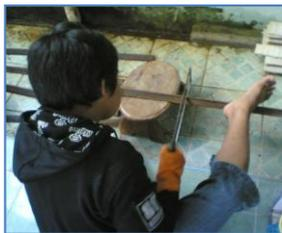
Gambar 35. Proses pemotongan besi siku
