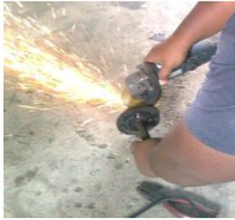
Gambar 25. Proses pengerjaan poros input dan gear input
