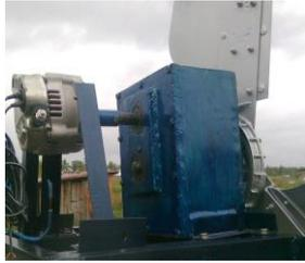
Gambar 34. Alternator dan gearbox
