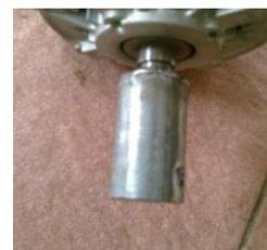
Gambar 33. Sambungan gear box ke alternator
