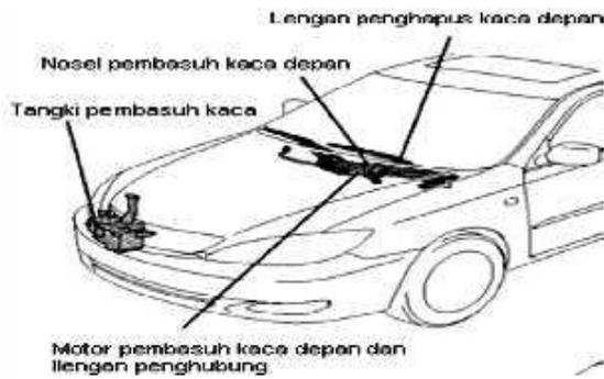
Gambar 1. Konstruksi Sistem Wiper Depan
