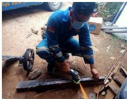
Gambar 8. Pemotongan Besi Siku
