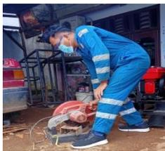
Gambar 9. Pemotongan Siku Besi UNP
