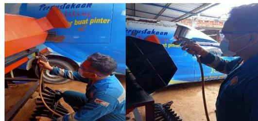
Gambar 12. Proses Pengecatan
