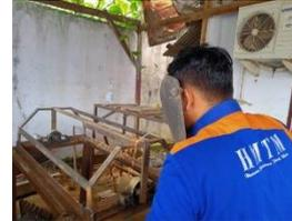
Gambar 10. Pengelasan Rangka
