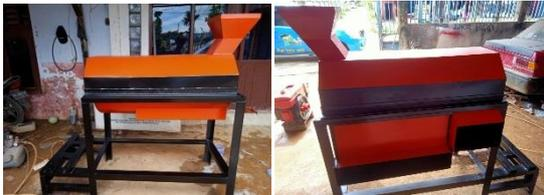
Gambar 14. Rangka Mesin Pengurai Sabut Kelapa
