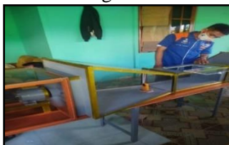
Gambar 9. Pengecekan Wilayah Terowongan Angin Yang Dipengaruhi Fungsi Diffuser
