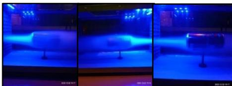
Gambar 14. Pola aliran angin benda uji silindris
