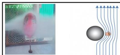
Gambar 22. Perbandingan mekanika fluida benda uji bola
