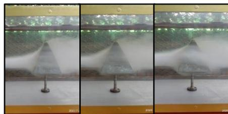
Gambar 16. Pola aliran angin benda uji piramid
