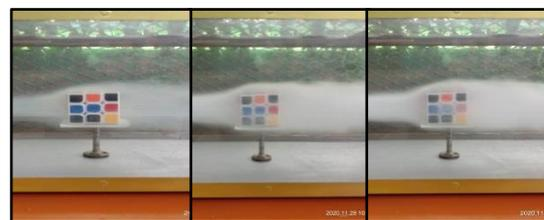
Gambar 10. Pola aliran angin benda uji kubus/kubistik
