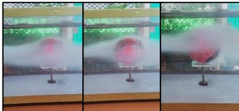
Gambar 12. Pola aliran angin benda uji bola
