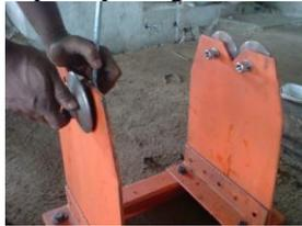
Gambar 27. Pemasangan rumah bearing
