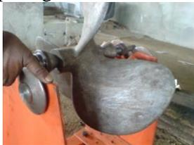
Gambar 28. Pemasangan poros dukung dan komponennya
