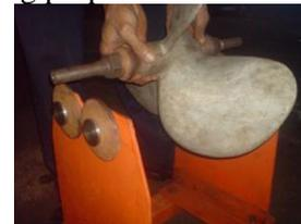
Gambar 30. Propeller dan poros yang sdiletakkan diatas alat
