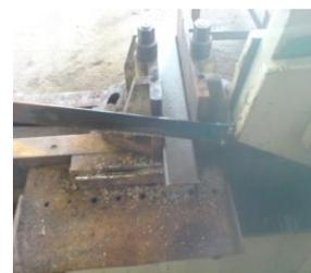
Gambar 15. Proses Pemotongan dengan Mesin Gergaji Listrik
