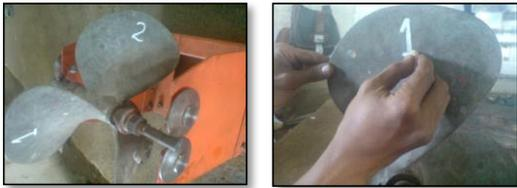
Gambar 31. Pemberian tanda pada daun propeller
