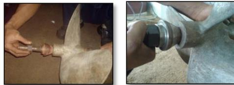
Gambar 29. Pemasangan propeller pada poros dukung
