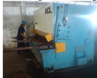
Gambar 5. Mesin Pemotong Pelat
