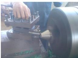
Gambar 18. Proses Pembuatan Penekan Propeller
