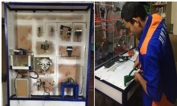
Gambar 7. Pasang Panel Akrilik pada Rangka
